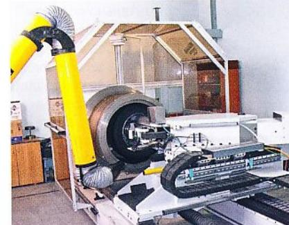
Стенд для динамического нагружения колес (как в продольном, так и в поперечном направлениях) производства немецкой компании Makra имитирует самые тяжелые условия движения: по горной дороге, на перегруженном автомобиле, резкие маневры. Суммарная нагрузка на колесо кратковременно может в три раза превышать номинальную (заявленную производителем). На этом стенде можно раскручивать колеса до угловой скорости, соответствующей 180 км/ч, но мы ограничились 120 км/ч
