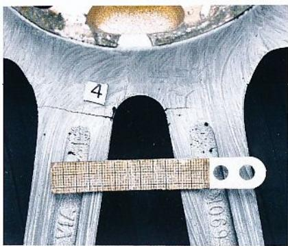
Эффектные колеса с имитацией болтов разъемного соединения диска с ободом выдержали даже удар с 60-процентным превышением нагрузки. И только в ходе циклических испытаний на стенде ZWARP на спицах появились трещины
